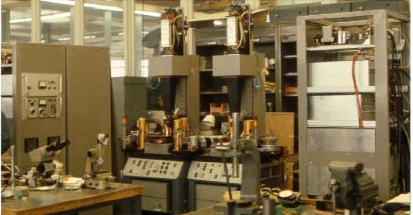
Laser à rubis de micro-usinage en cours de montage.
