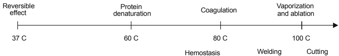
Effets obtenus en fonction de l'élévation de la température.
